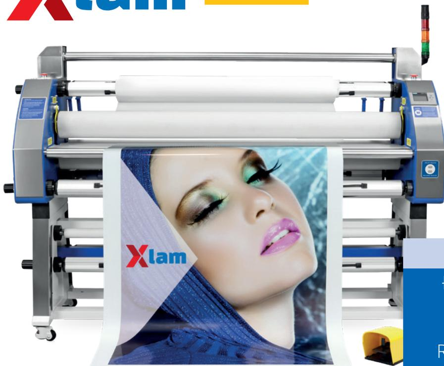
Laminatrice pneumatica roll-to-roll a caldo 1600 mm DEMO SHOWROOM. Completa di riavvolgitore, **due rulli riscaldati** da 130mm, temperatura massima **120°C**. Spessore materiale fino a 30mm Lame per il rifilo incluse. Grazie all'innovativo **sistema PLC Siemens®** e al sensore di fine materiale la macchina può essere gestita e monitorata da pc, tablet e smartphone. Adatta anche a laminazioni "linerless".
