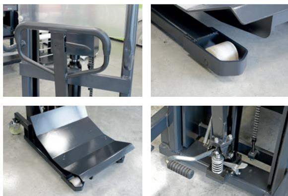
Elevatore pneumatico a pedale **carica bobine fino a 5mt di lunghezza, 1500 kg di peso e 80cm di diametro**. Larghezza della culla 70 cm, altezza del telaio 201cm. Riduce gli infortuni sul posto di lavoro, evita danneggiamenti ai materiali, permette di risparmiare tempo e denaro, un solo operatore per movimentare i materiali. Agile e maneggevole anche con spazio limitato, nuova barra di trazione e vassoio rinforzato. Profilo ribassato.
